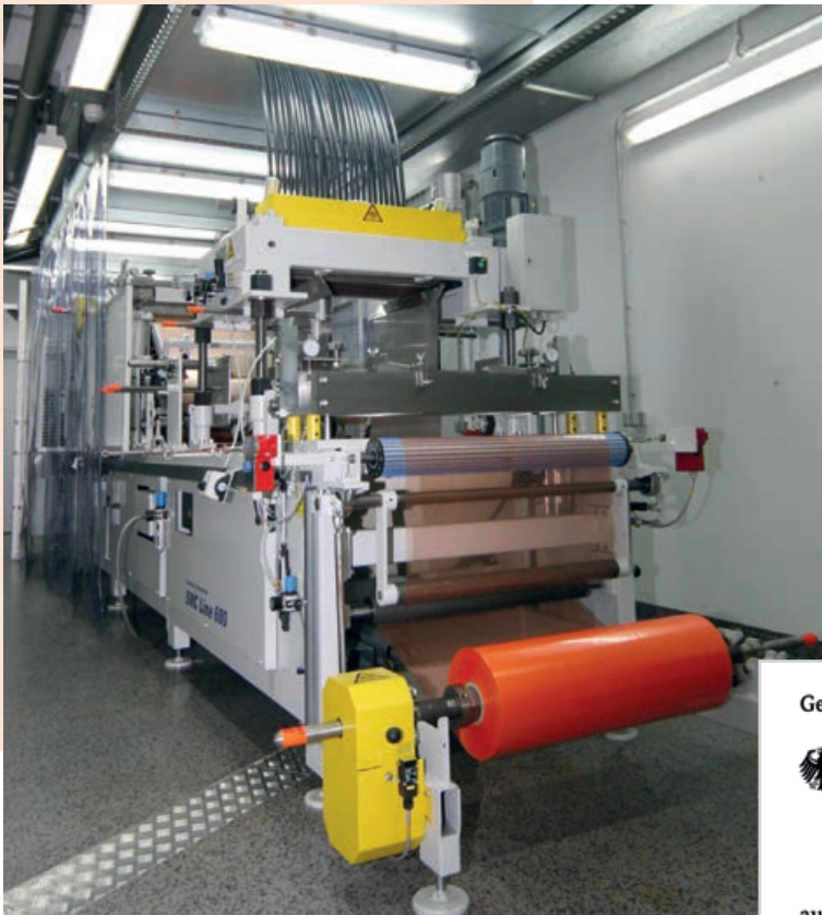
Institutseigene SMC-Anlage mit 600 mm Arbeitsbreite
