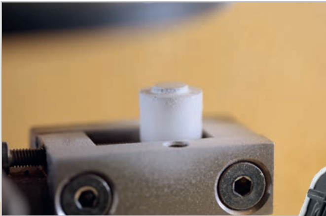
Abbildung des Stift-Scheibe-Versuchs Image of pin-on-disc test setup
