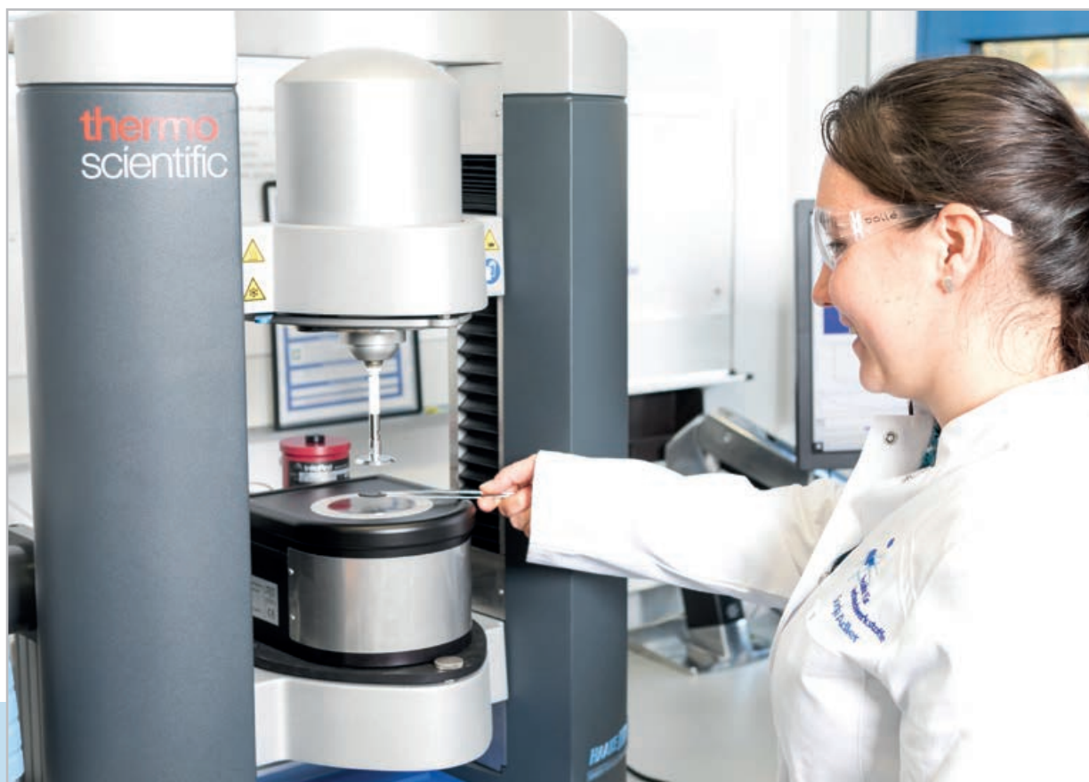
Einsetzen einer Probe am Plattenrheometer Inserting a sample into the plate rheometer
