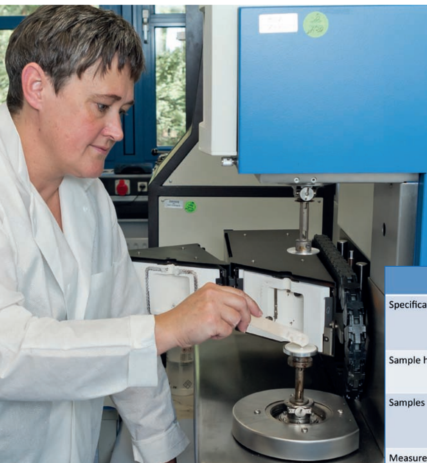
Probenauftrag am Plattenrheometer
