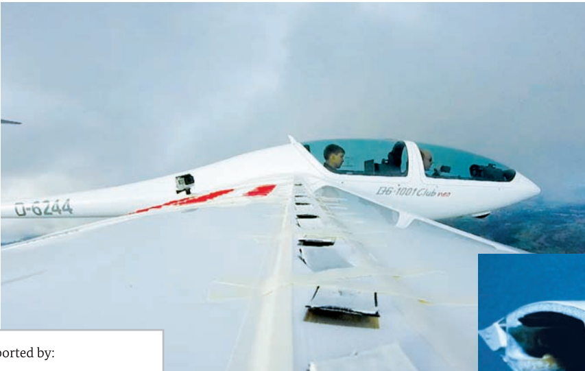
Aktive Turbulatoren im ausgefahrenen Zustand während des Flugversuchs
