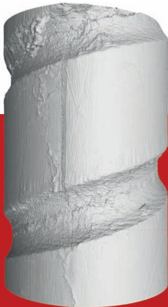
Scan eines pultrudierten GFK-Stabes ( \varnothing 9 \text{ mm} ) mittels Mikro-Computertomographie ( \mu\text{CT} ) zur Detektion von Schädigungsmechanismen nach Belastung
