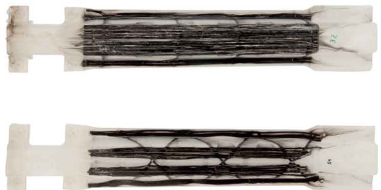
Verstärkungsgitter mit geraden Querstreben (oben) und diagonalen Querstreben (unten)
