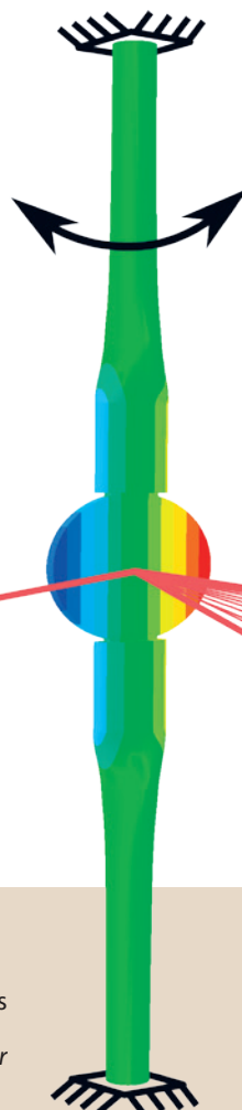
Aufbau eines resonanten Scanners
