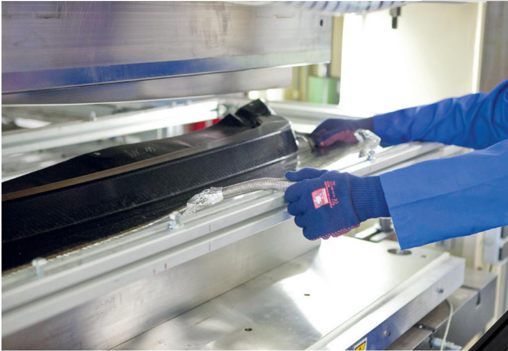
Formwerkzeug mit Demonstratorbauteil
