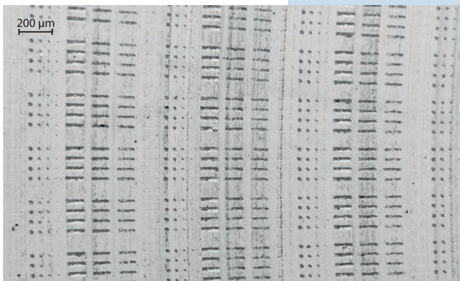
Laserstrukturierte Stahloberfläche nach tribologischer Prüfung (REM)
