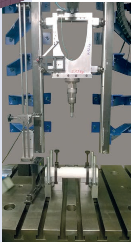
Versuchsaufbau zur Einbringung definierter Vorschädigungen durch Schlagbelastung in einen Stab
