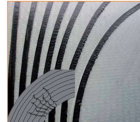
Unterschiedlich gekrümmte Tapelegepfade Different curved tape paths
