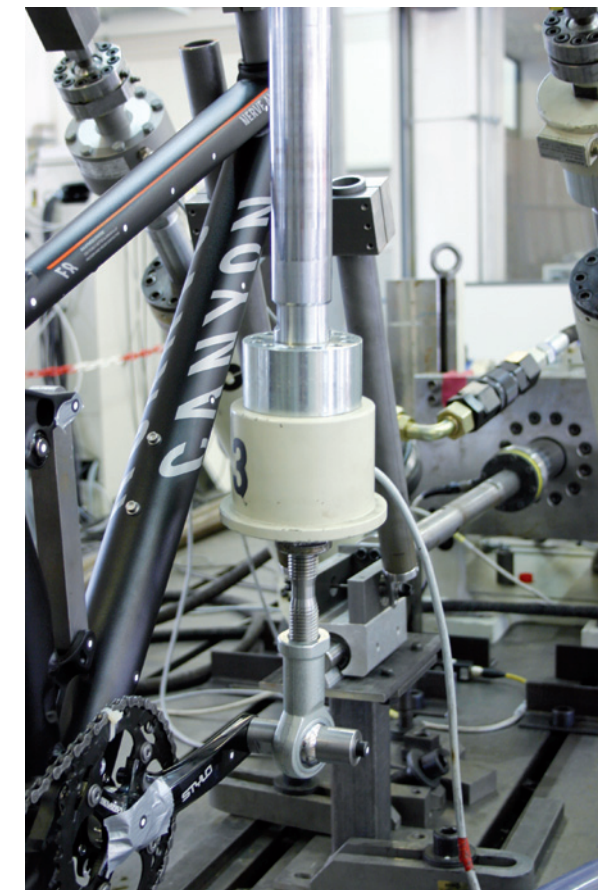
Betriebsfestigkeitsprüfstand für Mountainbikerahmen Service life test rig for mountain bike frames
