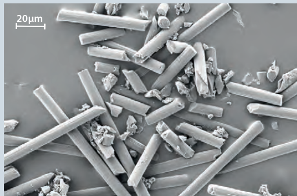
Aufgereinigter CNC-Frässtaub: REM von separierten Kohlenstofffaserbruchstücken zur weiteren Untersuchung des Bruchverhaltens
